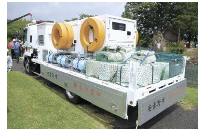
可搬式排水ポンプ（安曇野市）
