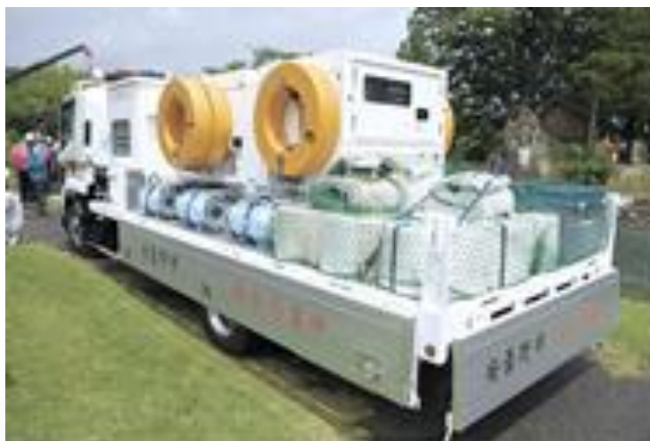
可搬式排水ポンプ （安曇野市）
